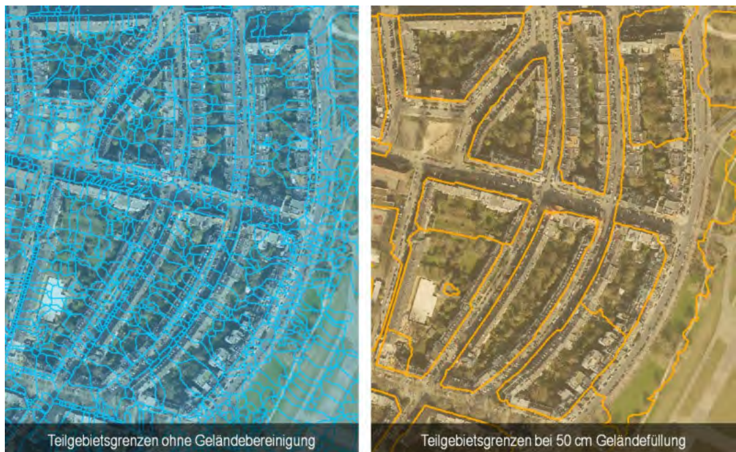
Abb. 33: Teilgebietsdiskretisierung bei unbereinigtem und bereinigtem Geländemodell (Beispiel)
