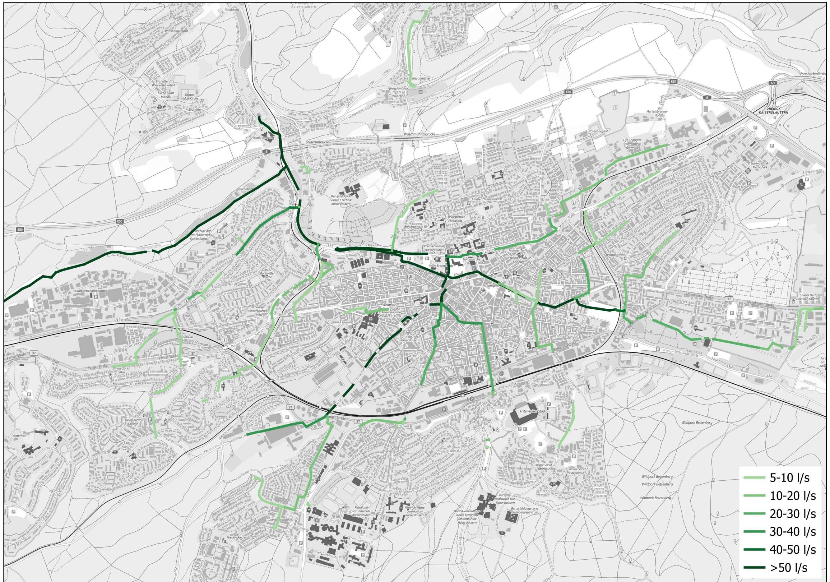
Abbildung 17: Abwasserkanäle (ab einer Durchflussgröße von 5 l/s) in Kaiserslautern (Abb. 37 im Bericht) (Fichtner, 2025)
