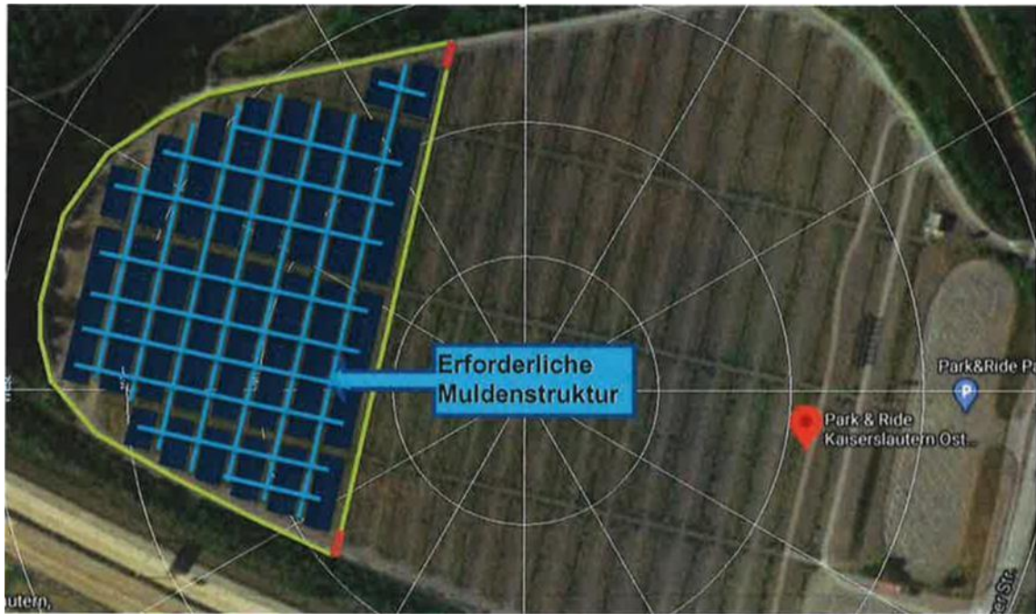
Abbildung 7: Oberflächenentwässerung zum Bebauungsvorschlag
