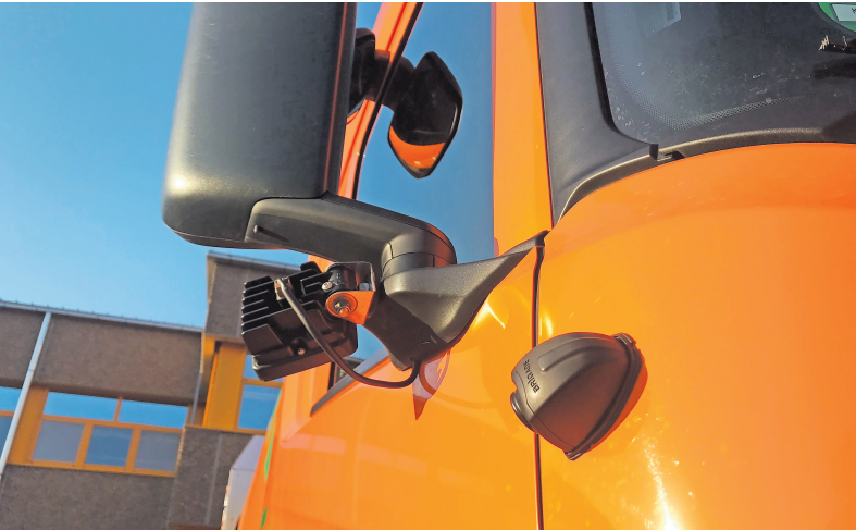
Die Kamera an der rechten Frontseite des SK-Entsorgungsfahrzeugs überträgt den seitlichen toten Winkel an den Monitor im Fahrzeugaum
