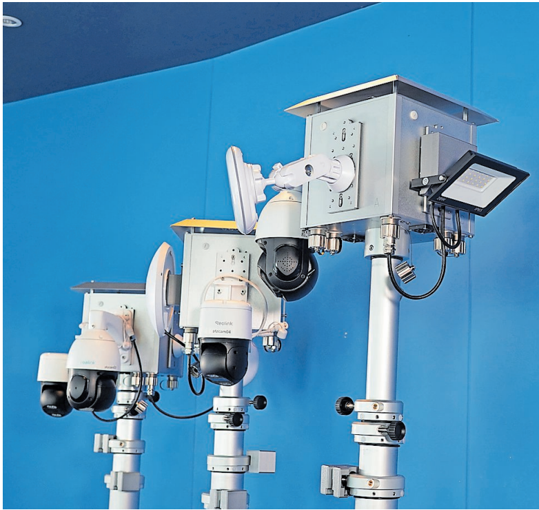
Vier Teleskopmastköpfe, wie sie auf der Kerwe im Einsatz waren, auf dem Bild beispielhaft bestückt mit Beleuchtung, Access-Points, Richtfunk und Videotechnik
