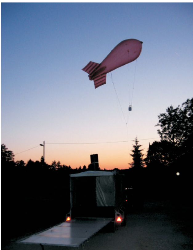
Abb. 20: Fesselballon mit Messsonde
