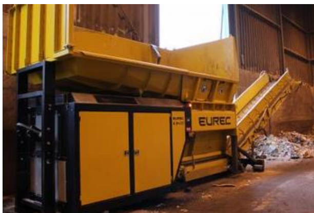
Abb.: Zerkleinerer für Sperrabfälle in der Umschlagshalle
