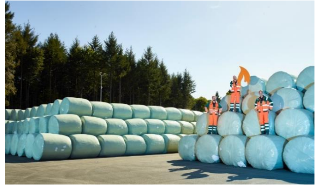
Abb.: Energiedepot – ballierter Restabfall im Zwischenlager
