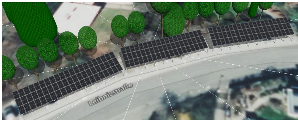
Abbildung 6-11: Anlagenkonfiguration Carport inkl. PV-Anlage
