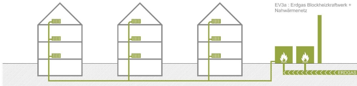
Abbildung 24: EV3a Erdgas BHKW + Nahwärmenetz (eigene Darstellung)
